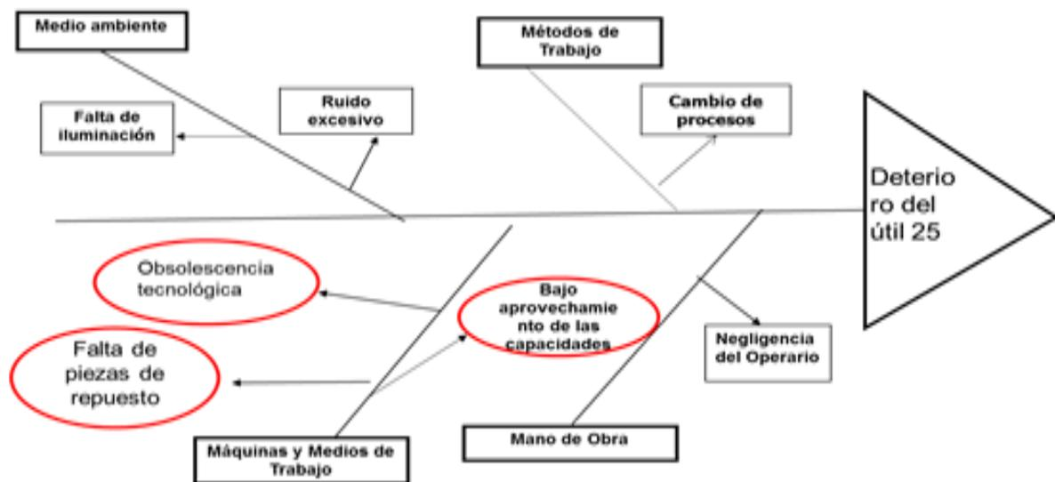
Figura 1. Resultados del análisis causal mediante diagrama de Ishikawa. Fuente: Elaboración propia.
